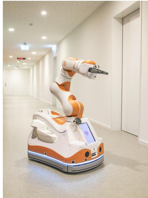
Das System „Lio“ kann mit einem Greifarm Getränke verteilen und bei Routineaufgaben in der Pflege helfen. (Foto: © F&P Robotics)
